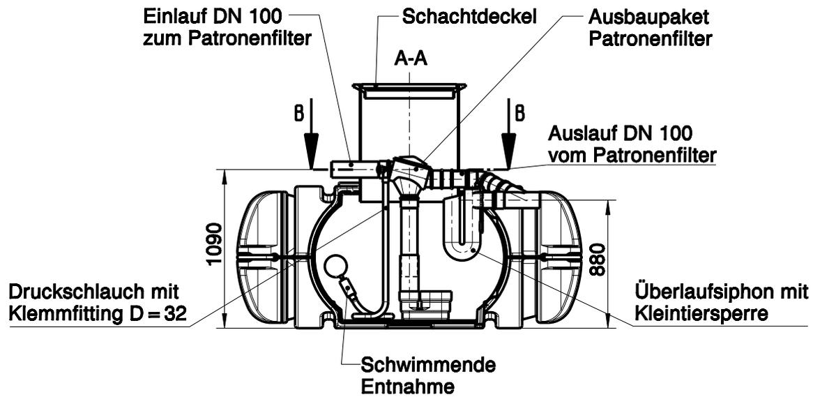
Domschacht vormontiert für Ausbaupaket Patronenfilter
